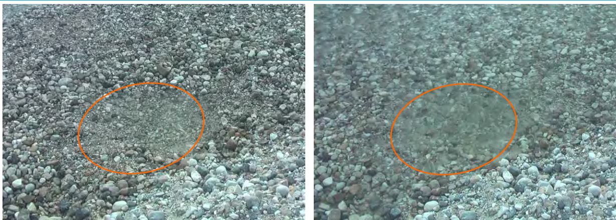
Abbildung 112: Muldenstrukturen in der Rinne 1 (VAo_7) – Sunk (links) und Schwall (rechts)
